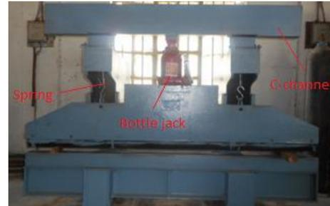
Figure 7 : Modified press brake
