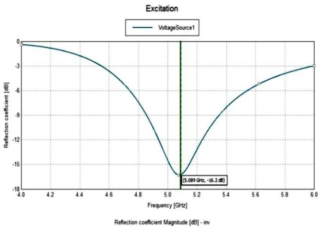
**Figure 3. (d)** S-parameter of inverted-F antenna
