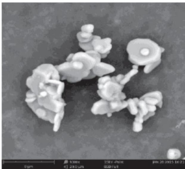
**Figure 3.** The filler particles( $Al_2O_3$ )
