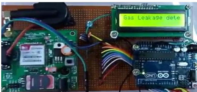
Figure 5.0 (d) Gas Leakage detection display on LCD
