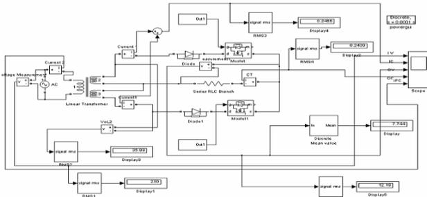
Figure 2(a). PWM Rectifier circuit
