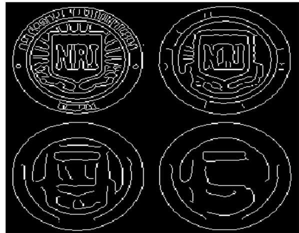
**Figure 3.3 :** Canny Edge Detection Techniques
