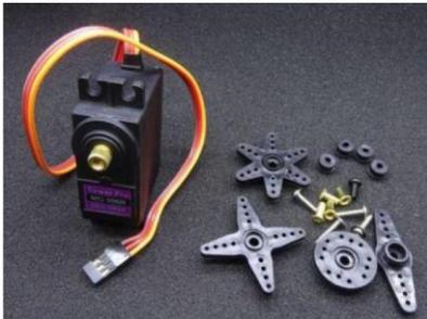
**Figure 4:** servo motor
