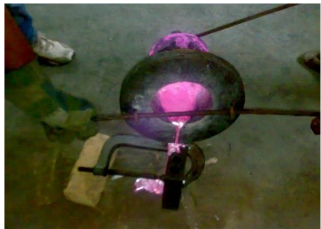
Fig. 4 Pouring of metal
